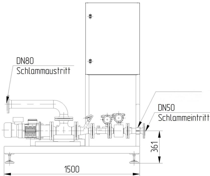
Mechanischer Aufbau und Anordnung der Komponenten. Abbildung beispielhaft, kann je nach Ausführung abweichen.
